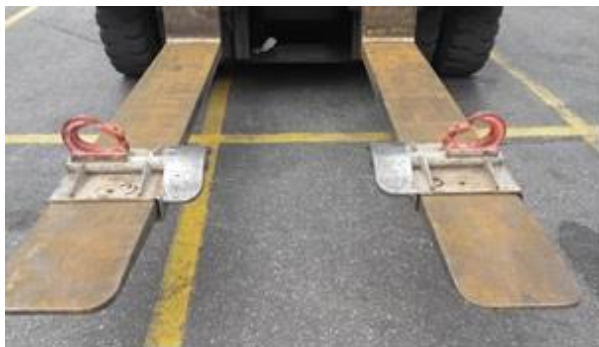
Slika 1: namenski nastavki za vilice za nakladanje kolotov pločevin (obstoječe)
