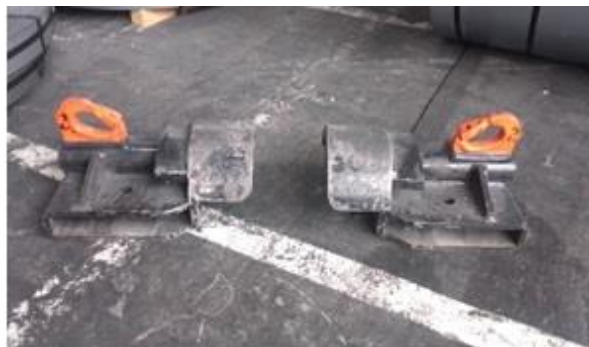
Slika 1: namenski nastavki za vilice za nakladanje kolotov pločevin (obstoječe)
