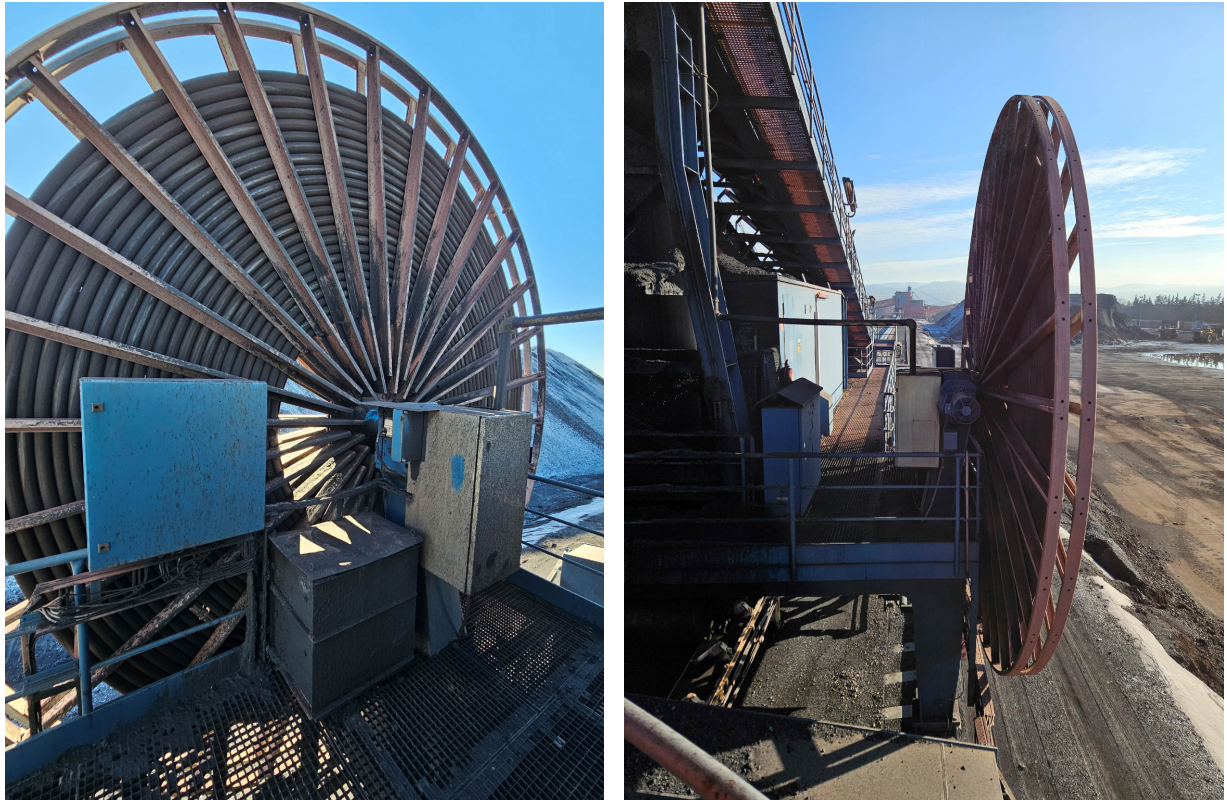
Slika 4 in 5 : Trenutna pozicija navijalnega bobna za vodo
